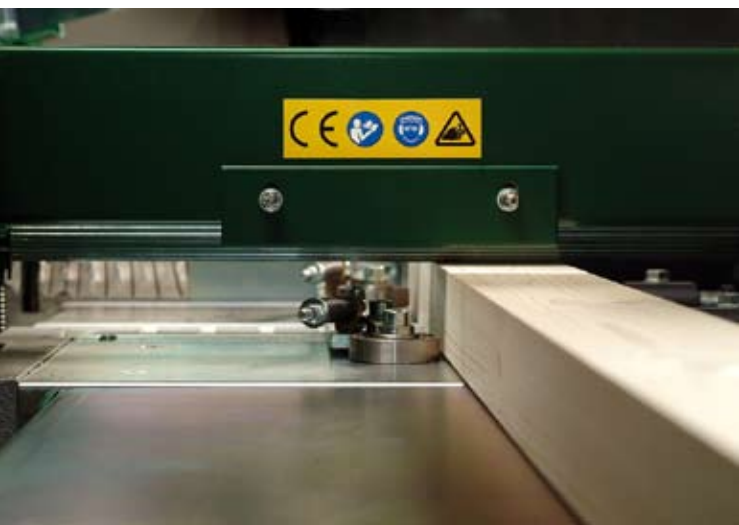
Standardowa prędkość posuwu wynosi 2-12 m/min, opcjonalnie może wzrosnąć do 4-24 m/min.
